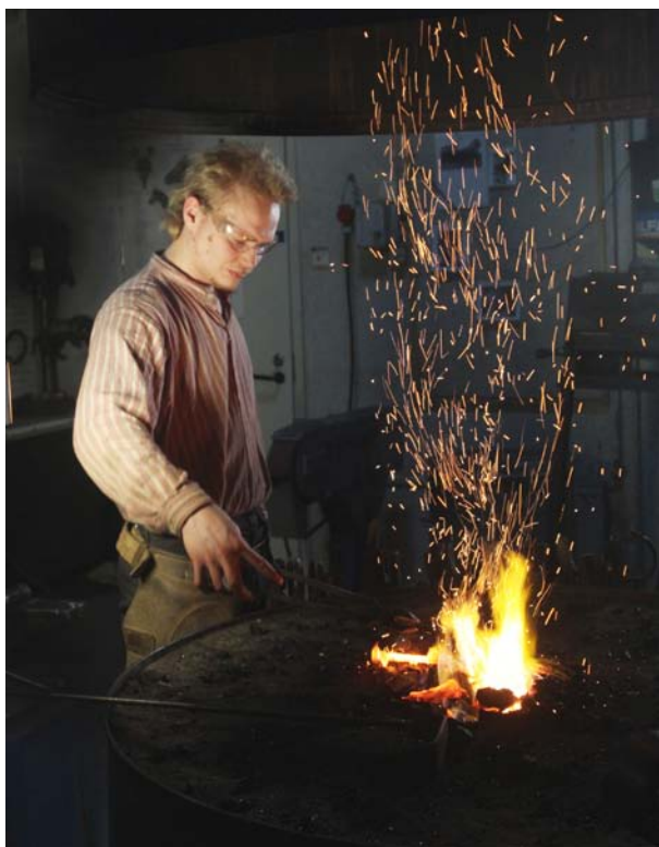
▲ Hevosenkengän kuumennus ahjolla ennen kavioon muotoilua. Kuva: Hevosopisto, Irina Keinänen
